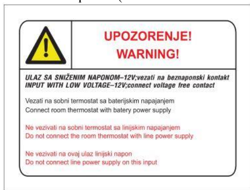
2. Nalepnica (Ulaz za sniženim naponom 12V) 60mm x 80mm
